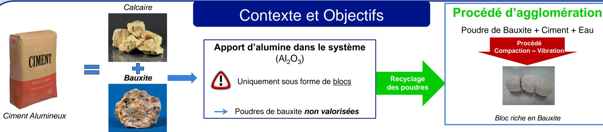
Etude de l'agglomération des poudres de bauxite mélangées à du ciment et de l'eau pour réaliser des blocs avec une porosité limitée, des tailles de pores faibles et des propriétés mécaniques élevées
