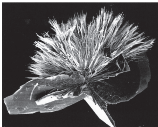
Figure I.5 : Photographie MEB de deux formes polymorphiques du dihydrate de dioxinate de cuivre : forme a (fibres) ; forme b (plaquettes) (Coquerel, 2006).
